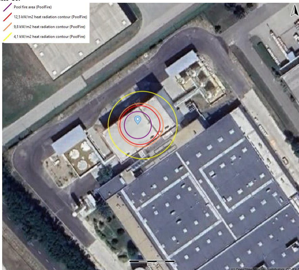
18. ábra: Veszélyes anyagot tartalmazó csővezeték törése- Tócsatűz
